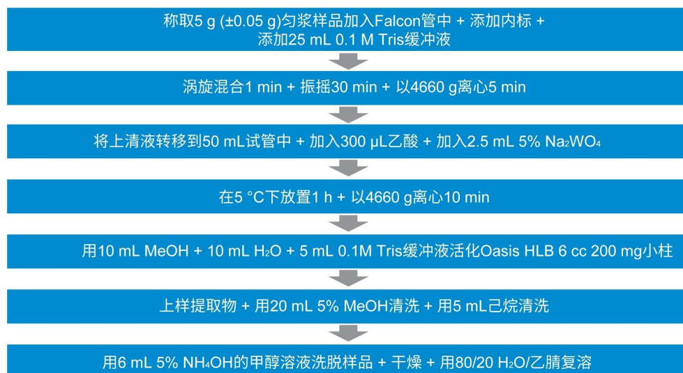
图1.样品前处理步骤概述
