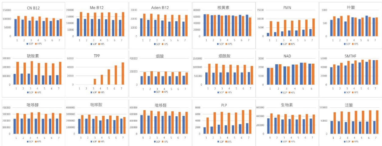
图2.采用HPS设置与SOP设置分析B族维生素及其同效维生素获得的LC-MS/MS峰面积比较。并绘制由不锈钢表面（SOP，蓝色数据条）与MaxPeak HPS（HPS，橙色数据条）获得的结果。
