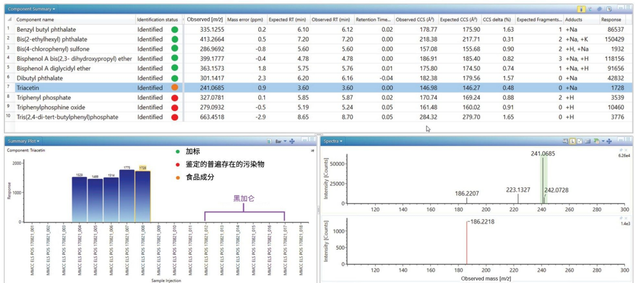
图1.ES+汇总图, 表明在橙汁、加标分析物和普遍存在的环境污染物中均检出三醋酸甘油酯。
