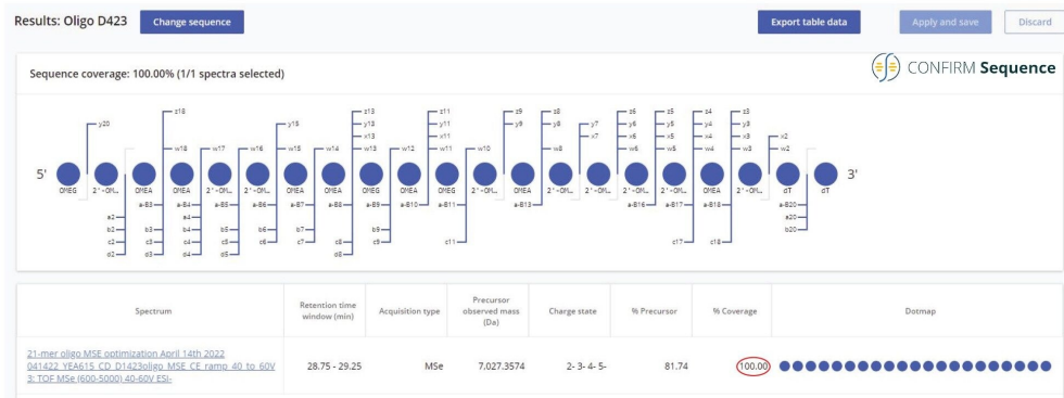
图5.以点图形式呈现的100%序列覆盖率，通过高能 MS^E 非靶向碎裂产生。在Xevo G2-XS仪器的碰撞室内施加最佳碰撞能量梯度(40~60 V)，对21-mer高度修饰寡核苷酸的所有母离子进行碎裂。
