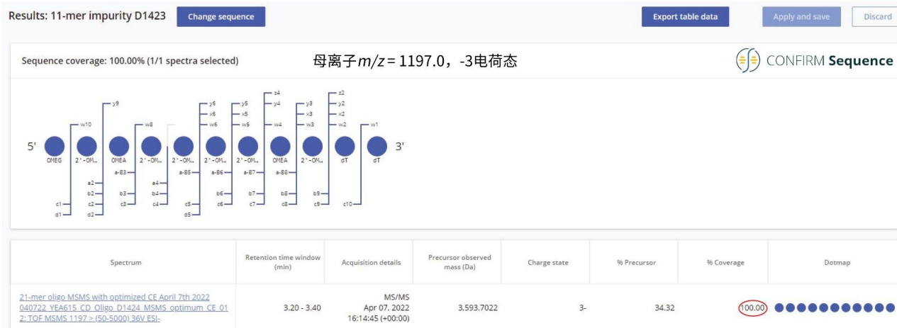
图8. MS/MS 碎裂 11-mer 寡核苷酸杂质的 [M-3H]^{-3} 母离子获得了 100% 序列覆盖率。在 Xevo G2-XS 仪器的碰撞室内使用最佳固定碰撞能量 (36 V) 对母离子进行碎裂。
