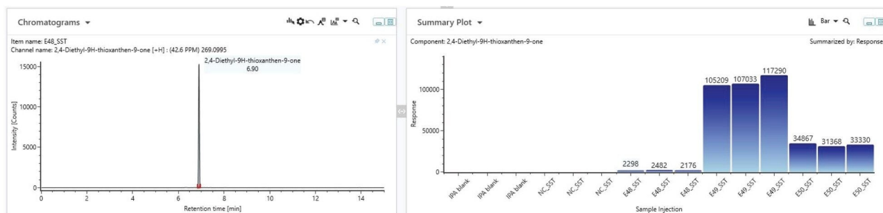
图4. 2,4-二乙基硫杂蒽酮的提取离子流色谱图以及该化合物在各样品中的响应。NC为阴性对照（萃取空白样），E48、E49和E50为萃取喷鼻剂样品的三次重复进样。
