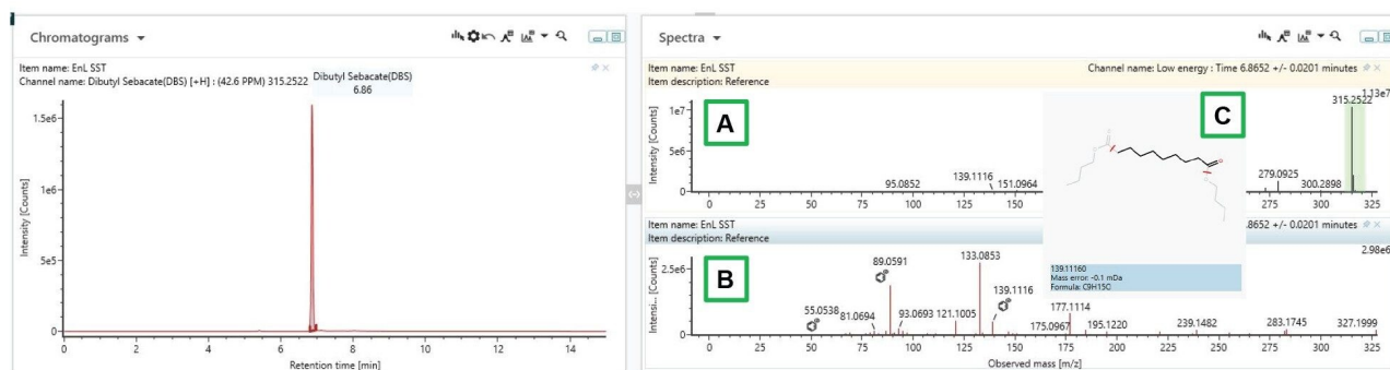
图3.癸二酸二丁酯的 MS^E 数据示例。[A]母离子 ( C_{18}H_{34}O_4 , 精确质量数315.2535, 质量精度: -1.0\text{ ppm} ) 的低能量谱图。[B]碎片离子的高能量谱图。[C]高能量谱图中的符号表示根据碎片离子和与之相关的质量精度可以指派一个鉴定结果。图中突出显示了电荷保留碎片。
