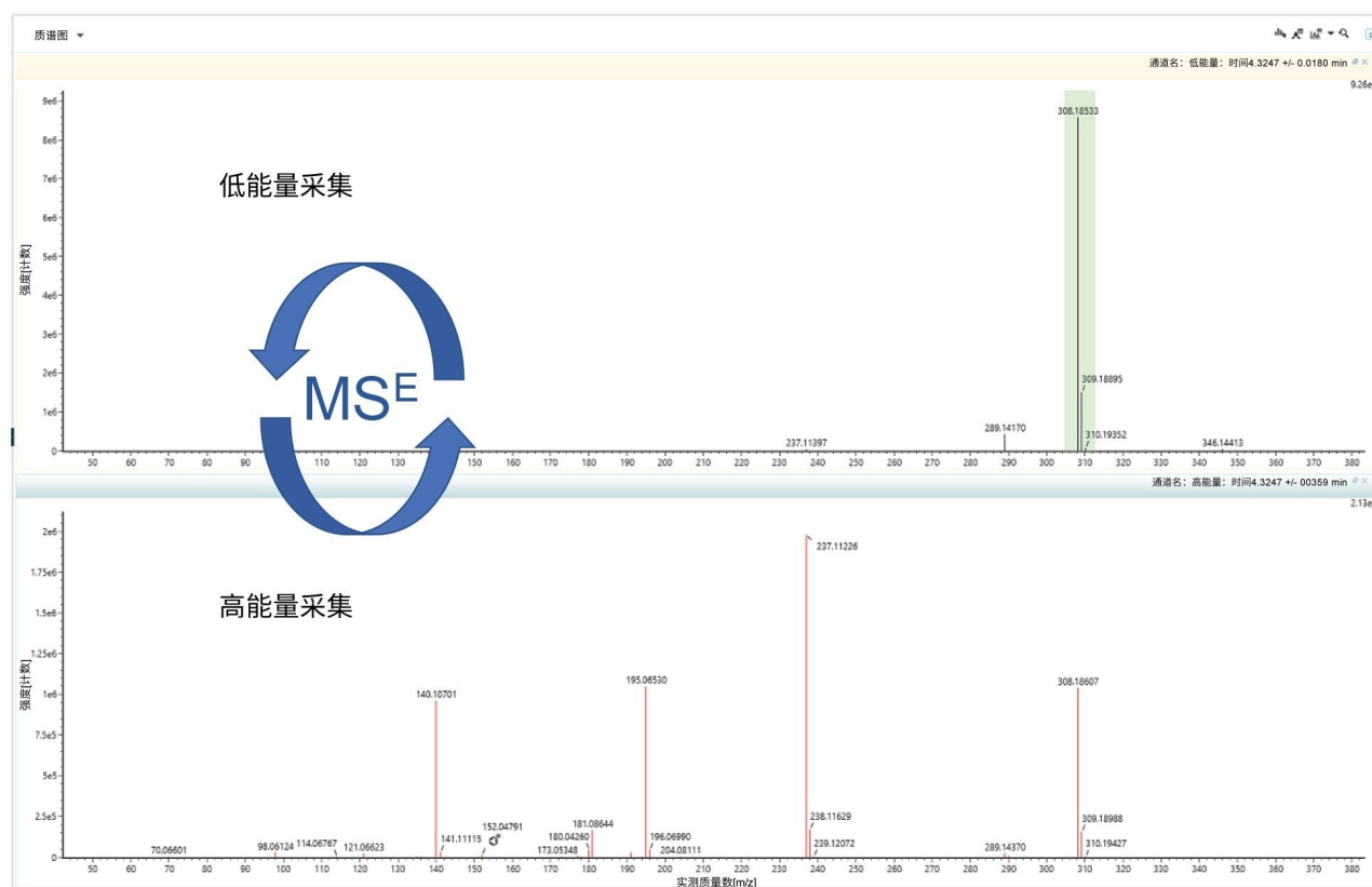
图1.使用MS E 获得的数据集是完整的；即使是邻近洗脱或共流出分析物，也一定能采集到母离子（显示在低能量质谱图中）和碎片离子（高能量质谱图）的完整准确质量数数据。
