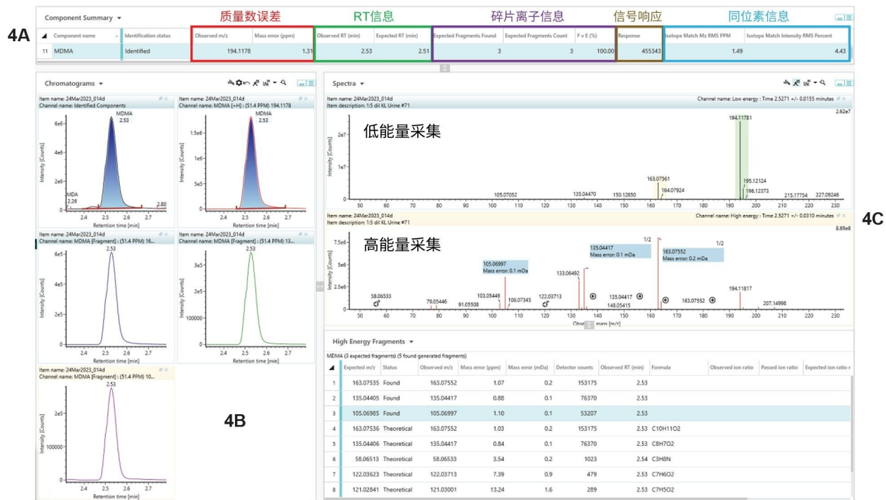
图4.靶向分析后样品中MDMA的检测结果。有大量信息可供查看（如有需要）。图中上方表格(4A)详细列出了采集数据与毒理学数据库中的参考信息的比较结果。窗格4B显示了目标母离子和3种特征碎片离子的提取离子流色谱图，证明所有离子都在6.36 min处时间对齐。低能量和高能量质谱图如窗格4C（上方）所示。碎片离子的详细信息列于下方表格中。
